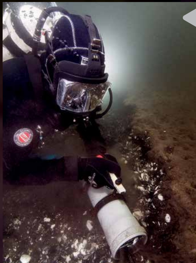
► 9. Diver using a sediment extractor / Ein Taucher beim Einsatz des Sedimentsaugers (Photo: M. Siegel, UWA-Logistik GmbH)
