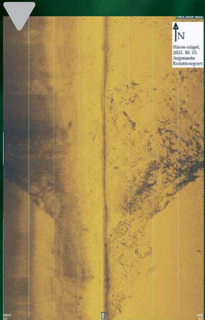
► 3. Mosaic of sonar images of the underwater debris-mound / A víz alatti omladékhalm szonárfelvételeiből készített mozaik kép (By :A. Tóth)
