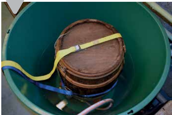
► 4. Desalination of barrel E-94 / Desalinizacija bačve E-94 (Photo: A. Jelić)
