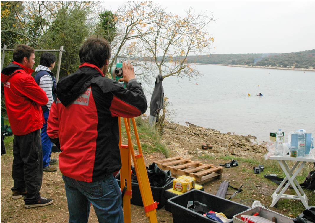
Snimanje mola totalnom geodetskom stanicom (foto: D. Milošević) / Ripresa del molo con una stazione geodetica totale (foto: D. Milošević)
